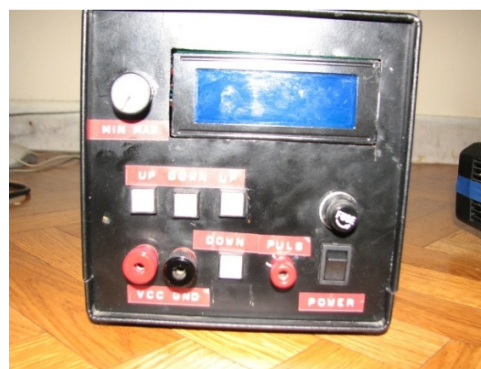
شکل (۴): تصویر واحد اصلی دستگاه تولید پلاسمای با قابلیت نمایش متغیرهای قابل تنظیم.
