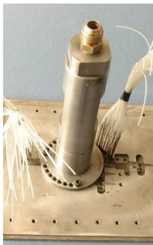
شکل (۲): تصویری از تجهیزات تولید جت مافوق صوت.
