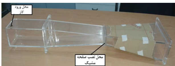
شکل (۶): مجرای ورودی گاز به بخش تست.
