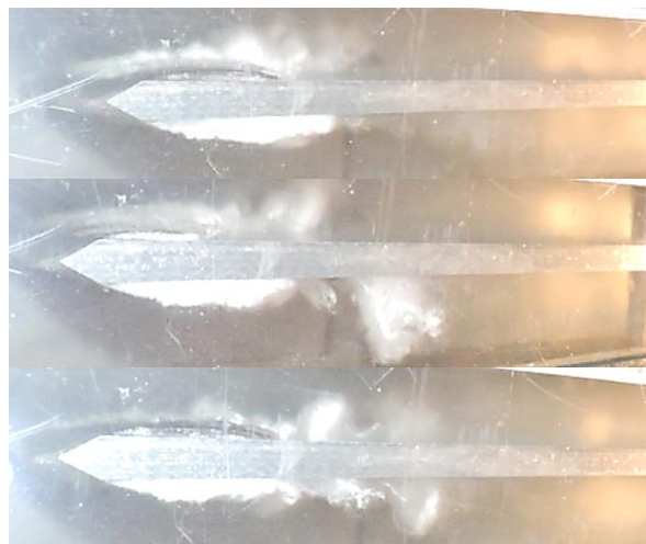
شکل (۷): گسترش طول کاویتاسیون لایه‌ای روی سطح بالایی مدل و ایجاد کاویتاسیون ابری در عدد کاویتاسیون 0/55 .
