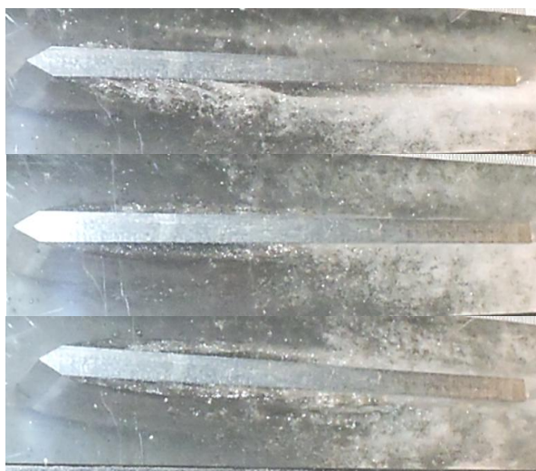
شکل (۹): پراکندگی حباب‌ها در اندازه‌های مختلف در پایین دست جریان در مرحله سوپر کاویتاسیون ( \sigma = 0/45 ).
