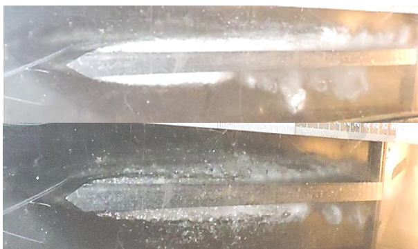
شکل (۸): دو رژیم کاملاً متمایز لایه‌ای با طول مختلف در عدد کاویتاسیون 0/48 .
