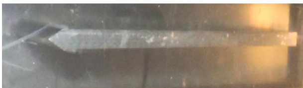
شکل (۳): آغاز کاویتاسیون به‌ازای \sigma = 0.75 در فصل مشترک بالایی و پایینی.
