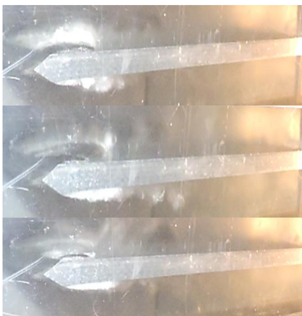
شکل (۵): کاویتاسیون ابری و لایه‌ای بر روی سطوح بالا و پایین در عدد کاویتاسیون ۰/۶۵۲.
