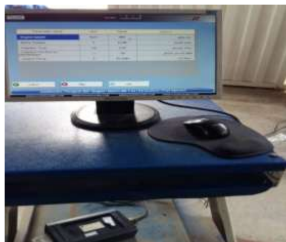
شکل (۲): دستگاه عیب‌یاب موتور بنزینی انژکتوری (دیاگ) در مرحله اول آزمایش‌ها ابتدا با فیلتر صفر کیلومتر (نو) و با استفاده از فشارسنج، فشار سامانه سوخت‌رسانی ابتدا قبل از
