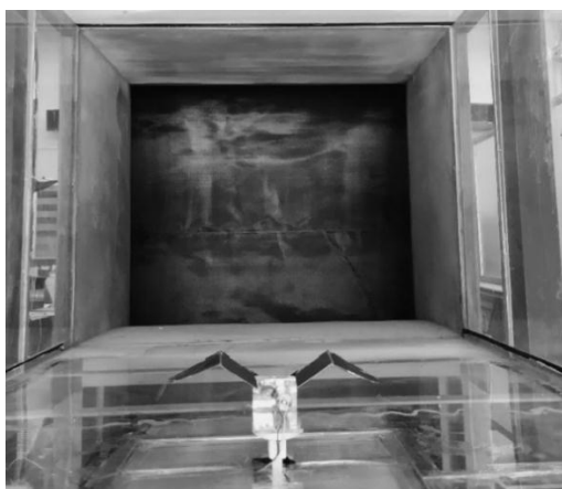
شکل (۴): بال و ساز و کار بالزنی با زاویه شکستگی در تونل
