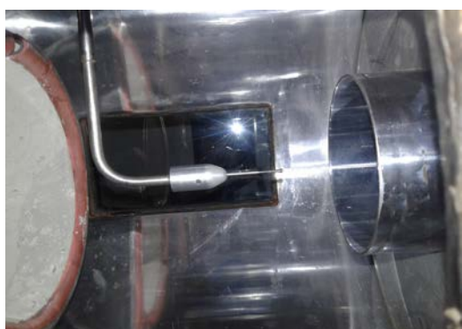
شکل (۶): محفظه آزمون تونل باد و مدل نصب‌شده در آن
