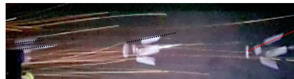
شکل (۴): تصویر نمونه از یک مدل (بالک بدنه) همراه با سابوت‌ها که در حال باز شدن هستند. زمان مابین سه بار فلاش هر کدام ۲ میلی‌ثانیه، زمان روشن بودن فلاش ۱ میکروثانیه و سرعت مدل پروازی ۲۹۴ متر بر ثانیه بوده است.
