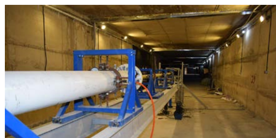
شکل (۵): سامانه پرتابگر مدل گاز فشرده در ابتدای تونل ایروبالستیک دانشگاه شیراز
