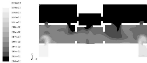
شکل (۱۷). کانتور توزیع دمای هوا بعد از مداخله ۱ در ارتفاع ۱/۴m برحسب کلوین
