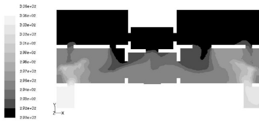
شکل (۲۱). کانتور توزیع دمای هوا بعد از مداخله ۲ در ارتفاع ۰/۷m برحسب کلوین
