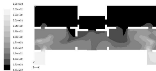
شکل (۲۲). کانتور توزیع دمای هوا بعد از مداخله ۲ در ارتفاع 1/4\text{m} برحسب کلوین
