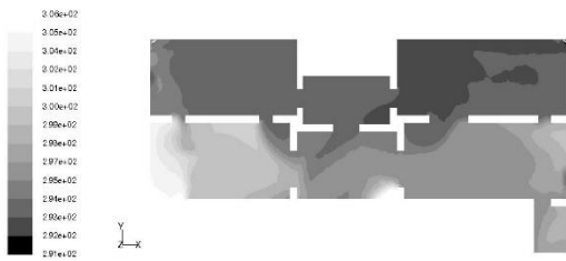
شکل (۸). کانتور دمایی وضع موجود بر اساس داده‌های تجربی: توزیع دما در ارتفاع ۱/۴m برحسب کلوین (K)
