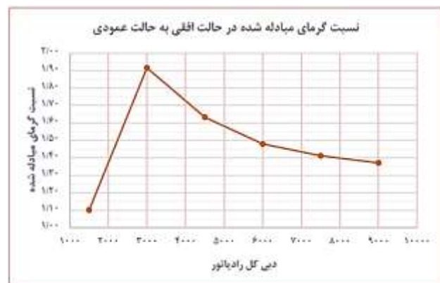
شکل (۱۰): نسبت گرمای مبادله شده در مبدل دارای لوله های افقی به عمودی
