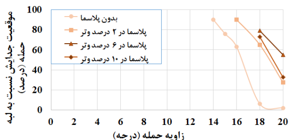
شکل (۱۲): موقعیت جدایش نسبت به لبه حمله برای تمام زوایای حمله به ازای جانمایی مختلف پلاسما
