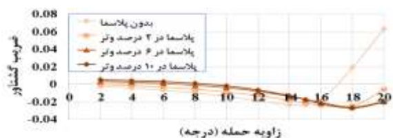
شکل (۱۱): ضریب گشتاور برای تمام زوایای حمله به ازای جانمایی مختلف پلاسما
