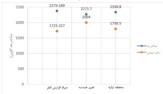
شکل (۱۴): مقایسه حداکثر دمای محفظه و حداکثر دمای خروجی در محفظه‌های با ابعاد متفاوت
