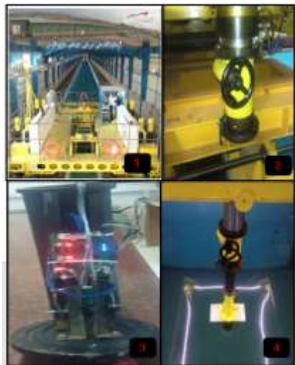
شکل (۱۰): ۱- آزمایشگاه ملی خلیج فارس ۲- دستگاه مانور مقید ۳- حسگر فشارسنج تفاضلی ۴- نحوه نصب حسگر به ارابه کشش
