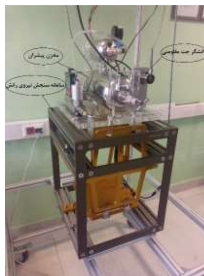
شکل (۱۵): آزمون تجربی سیستم پیشران جت مقاومتی:
