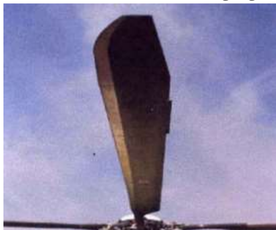
شکل (۲۸): پره ساکت برای بالگرد EC155 [۵۷]
