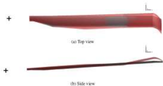
شکل (۴۳): پره اصلی (مشکی) و پره بهینه‌شده (قرمز) در پرواز ایستا [۱۰۴]
