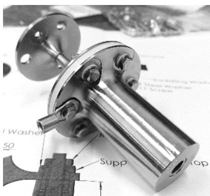
شکل (۱۶): نمونه ساخته رانشگر جت مقاومتی دما بالا [۱۰] رانشگرهای جت مقاومتی دما بالا (HTR ۲ ), رانشگرهایی هستند که قادرند دمای پیشرانه را تا محدوده ۳۰۰۰°K افزایش دهند. تعریف محدوده دمایی ۳۰۰۰°K نزدیک به حد دمایی فلزات نسوز با بالاترین نقطه ذوب و
