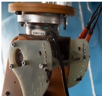
شکل (۵): صفحه درجه‌بندی شده و پین زاویه‌ای برای اعمال زاویه حمله
