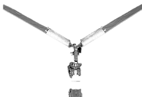
شکل (۳): پرنده بال‌زن در راه اندازه‌گیری آزمایش تونل باد
