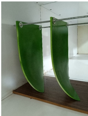
شکل (۴): شبیه‌ساز جریان باد پیچ‌خورده با پیچش ۳۰ درجه
