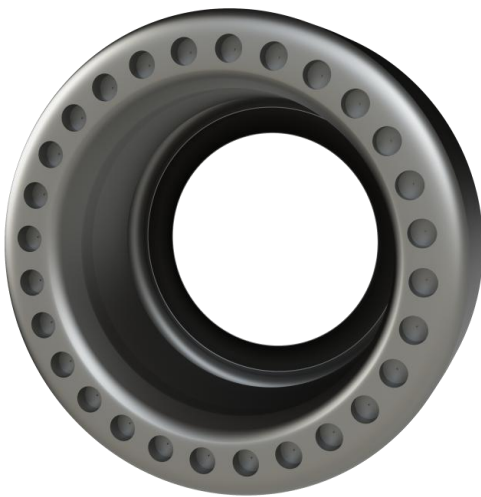
شکل (1): تصویر کامل محفظه احتراق موتور ALF502
