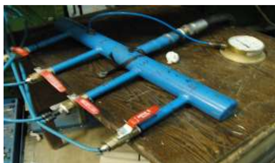
شکل (۱۰): تصویر دماغه پخ به همراه لوله‌های انتقال فشار و کلکتور دریافت هوای فشرده از مخزن پرفشار
